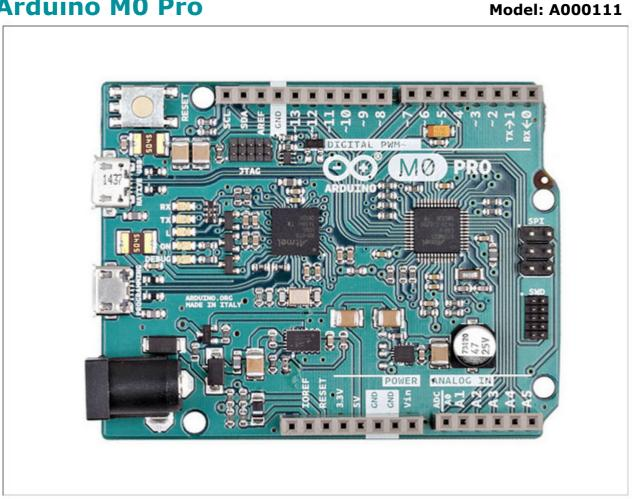
Arduino M0 Pro: il processore M0+ Atmel con l'integrato complementare ti permette di "debugare" la tua applicazione.
